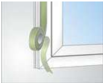
Slika 3: Sočelni spoj pri montaži oken
