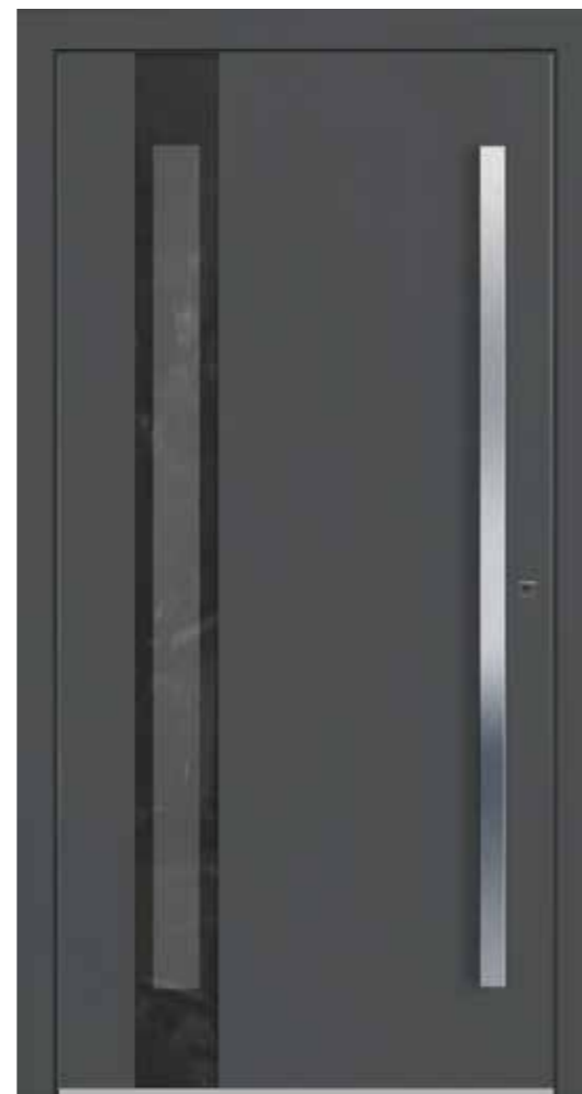
T33 Okvir: RAL 7016 Kriilo: RAL 7016 Ročaj: PLL 180 in oglata rozeta AJM Steklo: satinato z emajiranim črnim robom z Ug=1,1W/m2K
